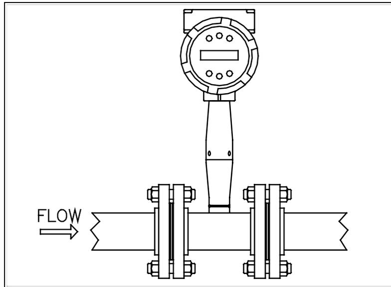
Figure 1-1. Series 220 In-Line Vortex Flow Meter
